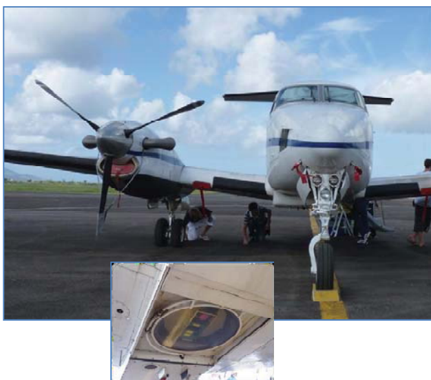
Photo 16. L'un des 4 aéronefs (Beechcraft 200) de la flotte IGN, avec le bloc laser par en-dessous
