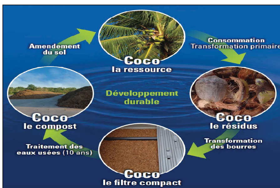
Figure 5. Le coco utilisé comme filtre pour le traitement des eaux usées, dans le cadre d'une démarche de développement durable
