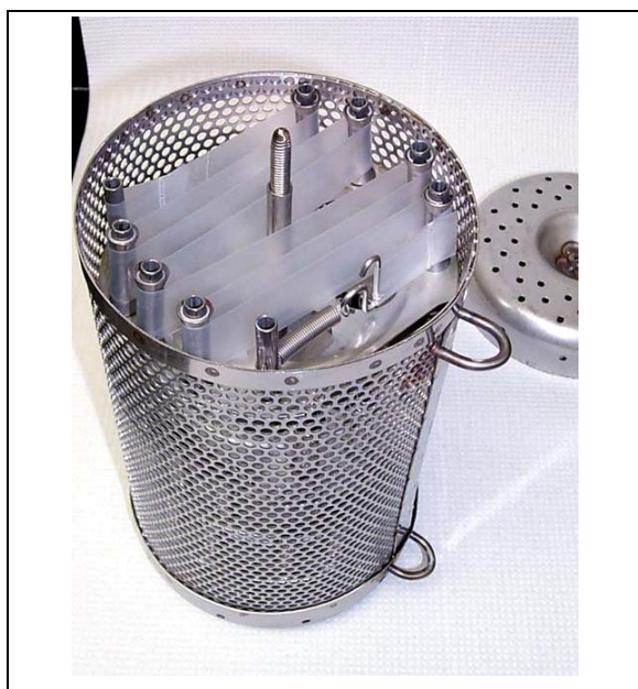
Photo 4. Système d'échantillonneur passif : SPDM dans son carter
