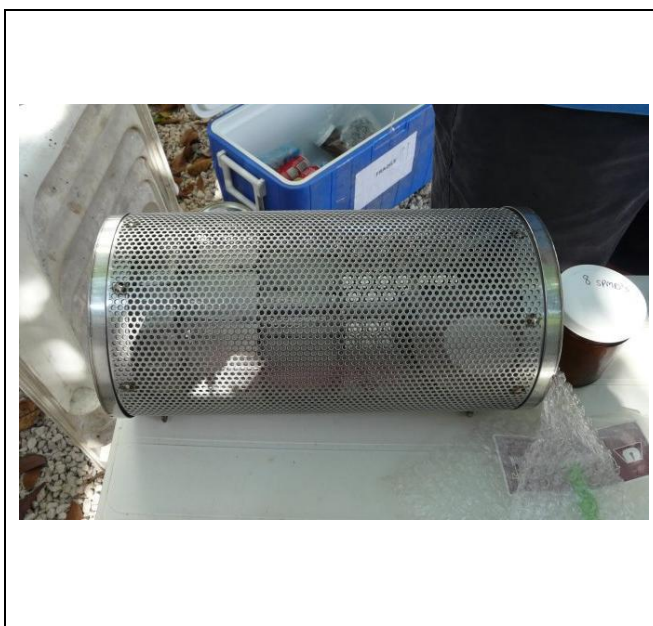
Photo 5. Echantillonnage passif : système prêt à être posé
