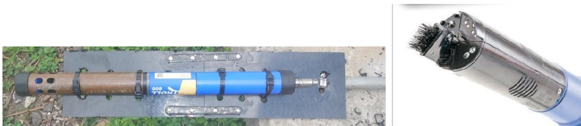
Illustration 33 : Sonde multiparamètre Aquatroll sur le support installé à proximité de l'Altus 1 et zoom sur le balais nettoyant intégré.
