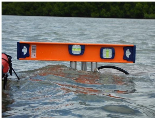
Illustration 4 : altus 4 : capteur immergé , altus 3 : capteur légèrement émergé pendant la marée basse, vérification de l'horizontalité.
