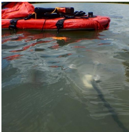
Illustration 4 : altus 4 : capteur immergé , altus 3 : capteur légèrement émergé pendant la marée basse, vérification de l'horizontalité.
