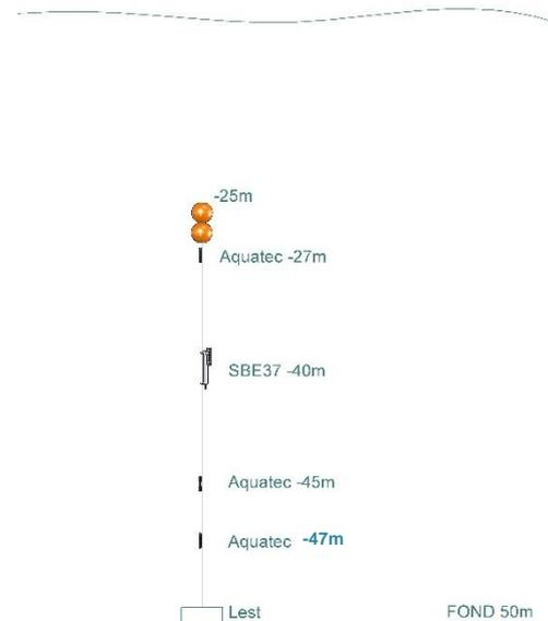
Schéma de mouillage de la Ligne 2
