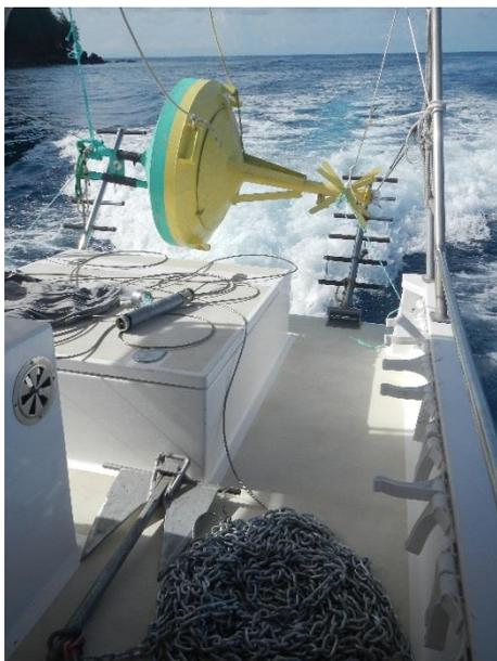
*Bouée et sa ligne de mouillage avant déploiement*
