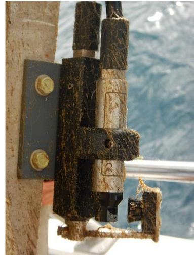
*OBS3+ à la récupération, l'écran de mesure est parfaitement propre au bout d'un mois de mesure*
