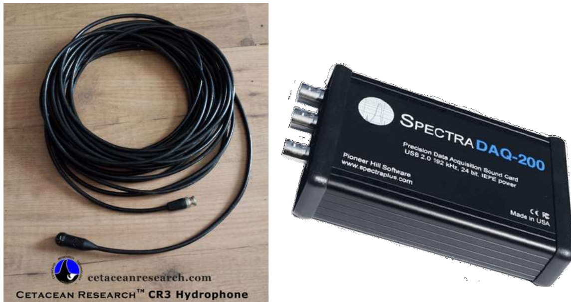
Figure 5: Gauche : Hydrophone CR3 avec ses 30m de câble. Droite : la carte d'acquisition SpectraDaQ-200.
