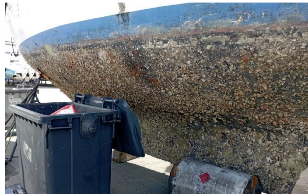
Carène encrassée avec fouling important
