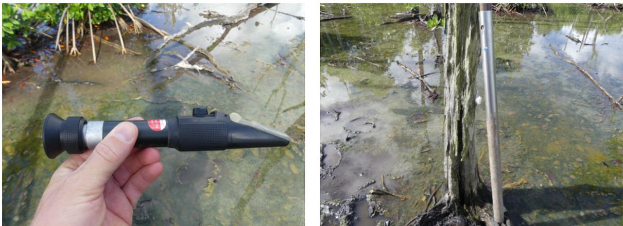
Figure 9. Refractomètre et tarière
