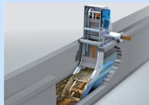
Dégrilleur automatique RakeMax HF
