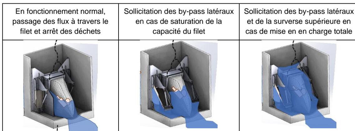
Figure 14 – Principe de fonctionnement dispositif F-reg
