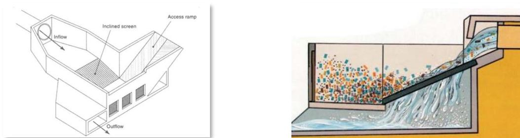
Figure 32 – Schémas de principe du dégrilleur incliné
