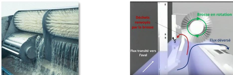
Figure 36 – Photo et schéma de principe du dégrilleur à brosse rotative
