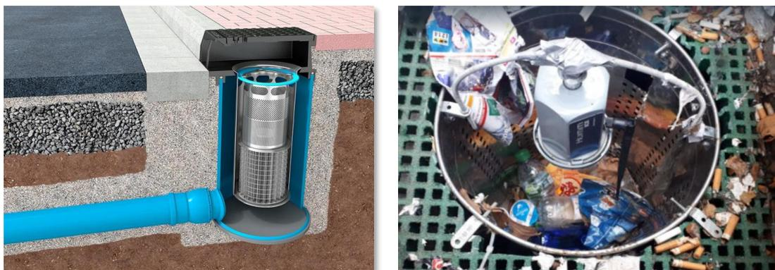
Figure 11 – Principe et exemple de panier d'avaloir (photo : SERAMM)
